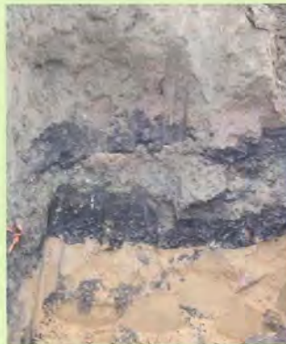
1 Unterscheidung Ober- und Unterboden
