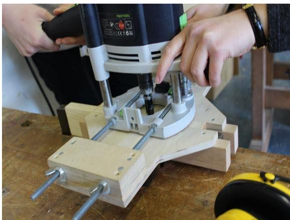
Abbildung 31: Freier Arbeitsteil: Herstellung der Frässchablone
