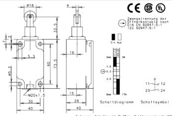
Toleranz: Schaltpunkt :0.25mm; Betätigungskraft :10%
