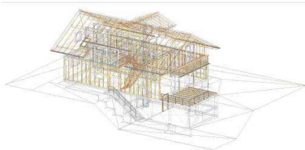
**Abbildung 5: Das Mustergebäude im Drahtlinienmodell (Grafik Bubiza)**
