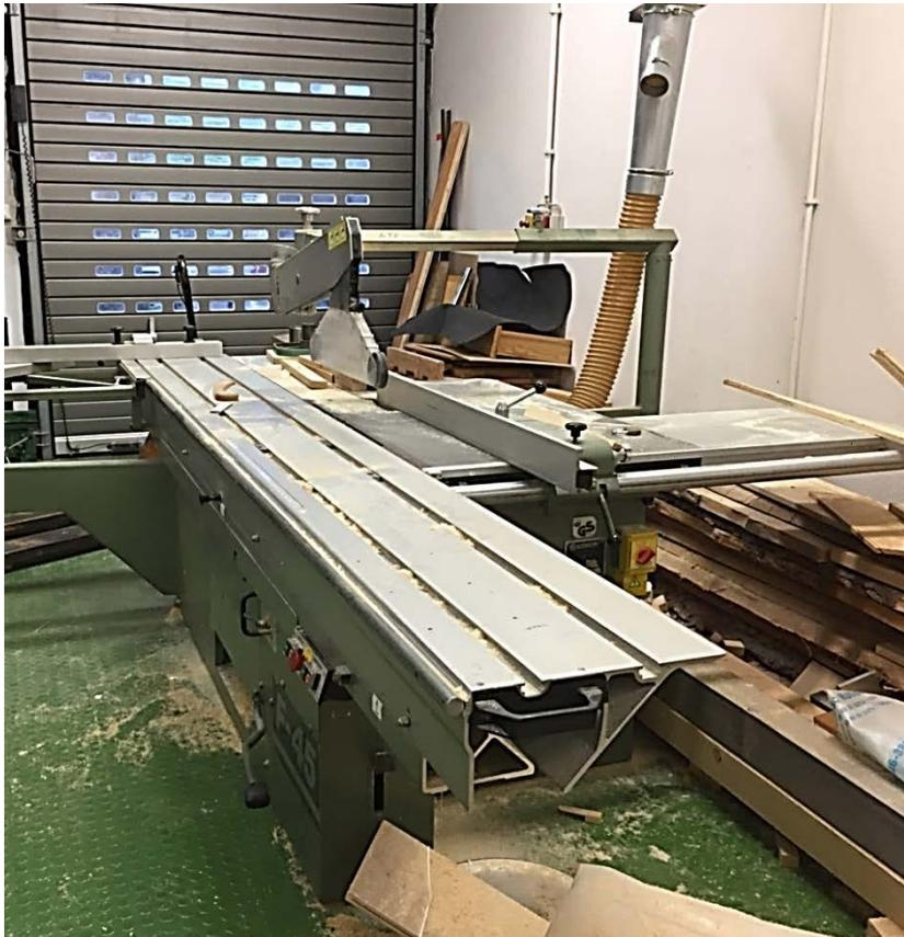
Abbildung 5: Formatkreissäge in der Holzwerkstatt
